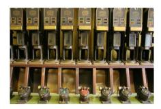
Posta pneumatica: tecnica sviluppata nel corso del XIX sec è stata spesso utilizzata per trasmettere plichi o piccoli oggetti tra uffici dello stesso fabbricato. Sono state anche sviluppate reti molto estese (50 km) e progettate per il recapito di pacchi pesanti. Ancora in uso per specifiche esigenze (banche, ospedali ..).
